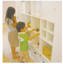
標準: 既製品又は設置スペースのサイズによっては現場造作で作成します。将来、重量物を置くことを 考慮し、プランにより床補強を行います。
